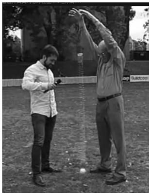
图4 下端挂网球的弹簧下落过程
