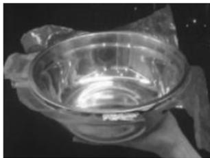
图1 自制的简易电容器
