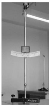
图 1 单摆测定重力加速度实验装置
