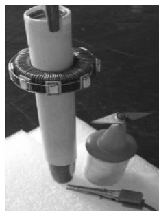
图7 用“电磁感应笔”“磁生电”和“电生磁”
