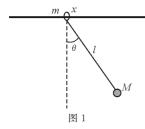
更简捷、更程序化的推导方法是用分析力学的 拉格朗日方程<sup>[3]</sup> 求解:设广义坐标为m 沿水平杆运动的坐标x 和M 摆动的角度 $\theta$ ,则  $x_M = x + l\sin\theta$  $y_M = l\cos\theta$
