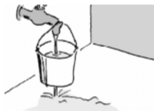
图2 流入桶的水量等于从洞中流出的水量,桶中水量不变
