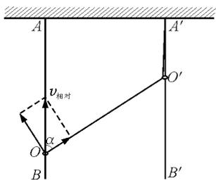
图9 绳子末端速度分解
