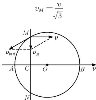
图3 绝对速度、相对速度、牵连速度几何关系
