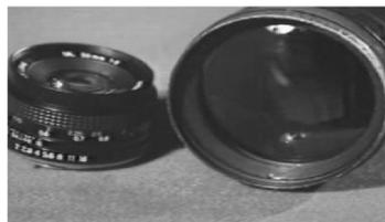
图 7 表面镀有增透膜的照相机镜头
