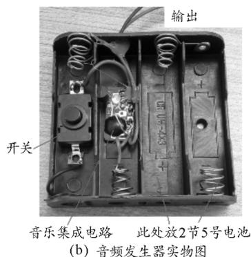
图6 自制简易音频发生器原理及实物图
