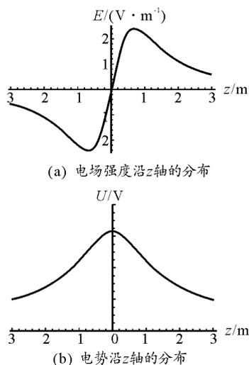
图 6 均匀带电细圆环中心轴的电场强度和电势分布
