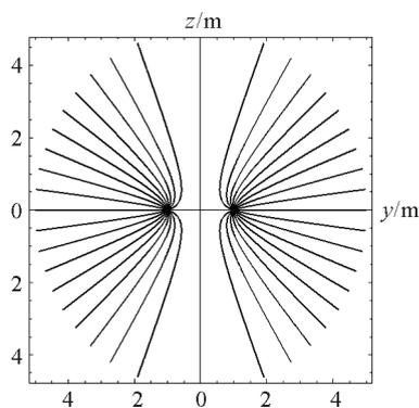
图5 均匀带电细圆环在  $Oyz$  平面内的电力线
