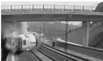
图5 西班牙一列火车超速转弯脱轨
