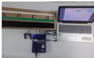
图4 探究钢球在粗糙程度不同的斜面滚下,机械能减少量是否一样
