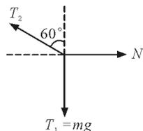
图4 图2中轻绳上与轻杆右端接触点受力分析
