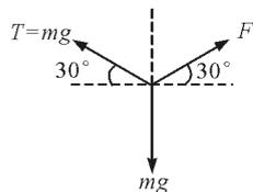
图3 图1中绳子上与滑轮接触点受力分析
