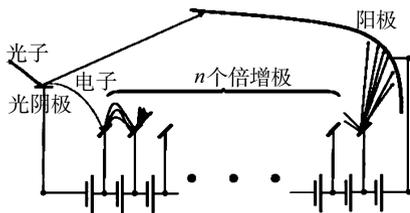
图1 光电倍增管结构图
