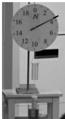
(a) 将一重物挂在圆盘测力计下方
