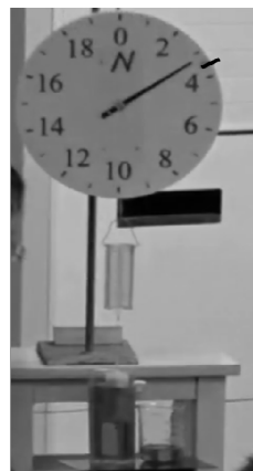
(b) 将溢水杯慢慢抬起, 重物逐渐浸入溢水杯, 测力计示数变小
