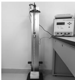
图1 测量单个弹簧劲度系数实物图
