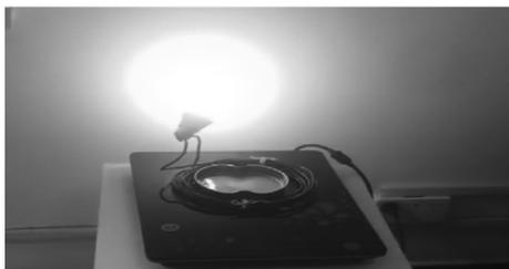
图2 无电源闭合回路中的灯泡放在电磁炉上变亮
