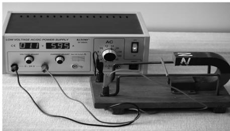
图1 探究磁场对电流作用实验装置
