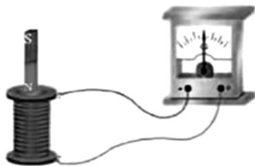
图 6 将磁铁插入或拔出螺线管的示意图
