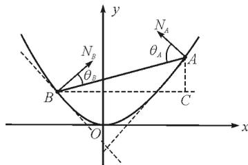
图2 采用力平衡与力矩平衡法分析图
