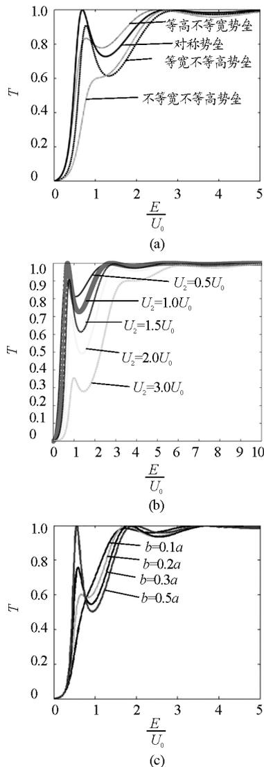
图2 透射系数随电子能量的变化
