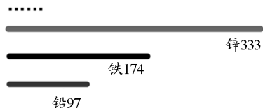
图 4 用长度表示不同金属的导电性
