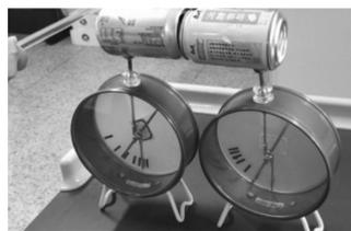
图4 笔者设计的静电感应演示实验装置
